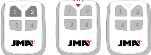
*Pulse simultáneamente los botones 1 y 2 hasta que el led rojo empiece a parpadear. Suelte y espere a que se apague.*
